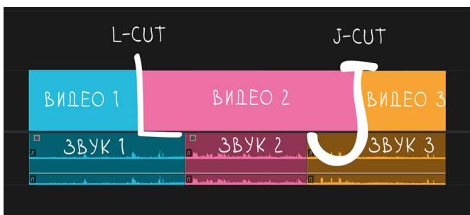
Иллюстрация применения косых склеек L-cut и J-cut при монтаже.
